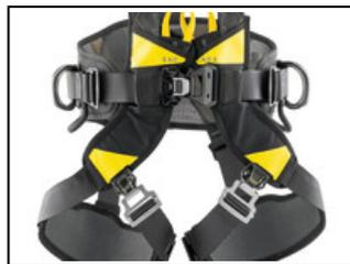
Hüftgurt und Beinschlaufen sind mit FAST LT PLUS- und FAST LT-Schnallen ausgestattet, die das Anlegen des Gurts mit den Füßen am Boden ermöglichen. Dank dieser Schnallen kann der Gurt angelegt werden, ohne die Einstellung zu verändern.
